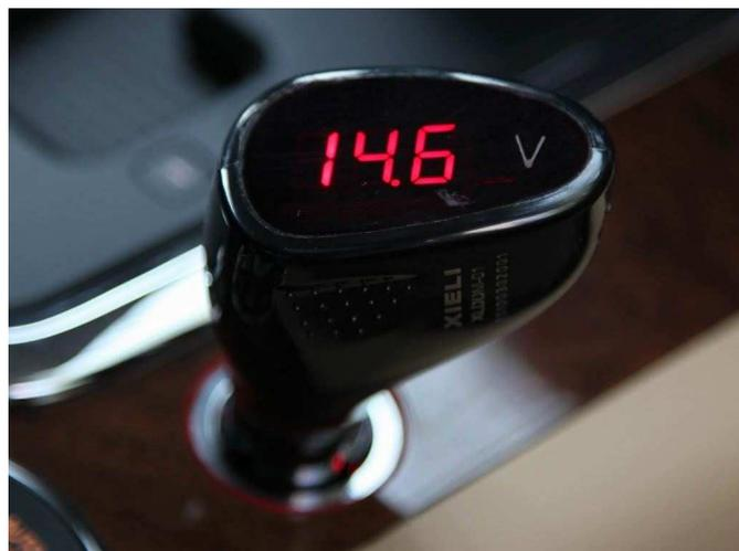
**Lichtmaschinen-Tester inkl. Prüfwerte**
